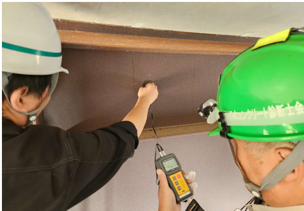
高所作業車による調査 (鋼橋桁の板厚測定)
