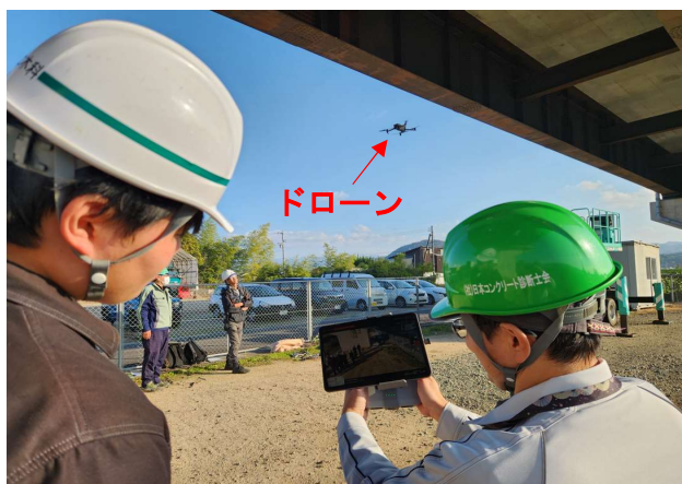
コンクリート調査 (ドローン撮影画像のリアルタイム確認)
