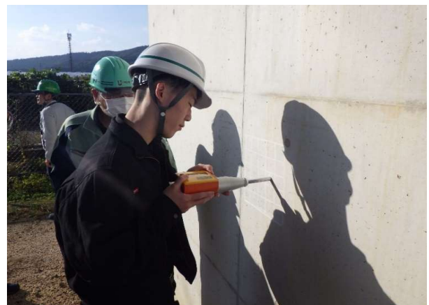
コンクリート調査 (シュミットハンマーによるコンクリート強度推定)
