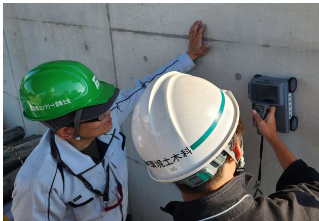
コンクリート調査 (RCレーダーによる鉄筋探査)
