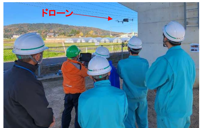
コンクリート調査 (ドローン撮影画像のリアルタイム地上確認)
