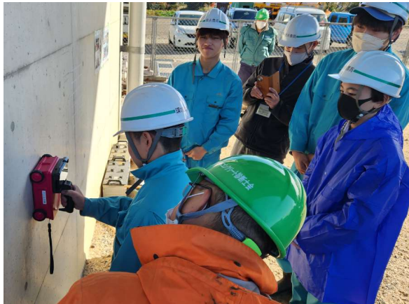
コンクリート調査 (RCLレーダーによる鉄筋探査)
