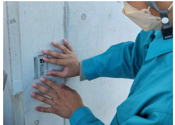
コンクリート調査 (クラックスケールによるひび割れ幅測定)
