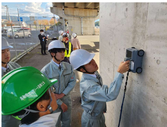
コンクリート調査 (RCLレーダーによる鉄筋探査)
