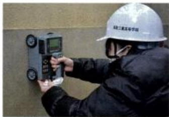
RCLレーダーを使って鉄筋の位置を確認する生徒
