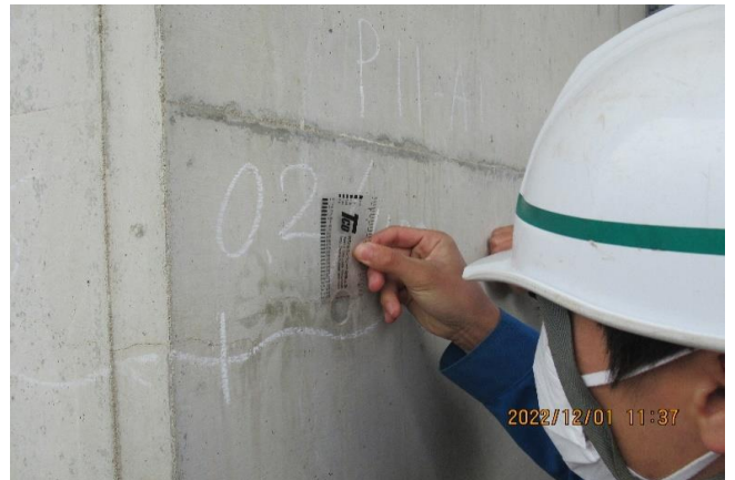
コンクリート調査 (クラックスケールによるひび割れ幅測定)
